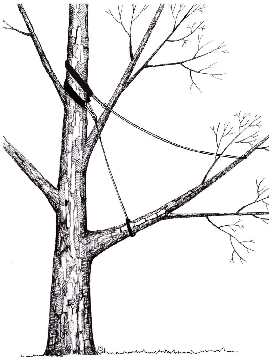
Obrázek 6 : Zajištění vodorovné větve, pro zabránění poškození v případě jejího selhání
